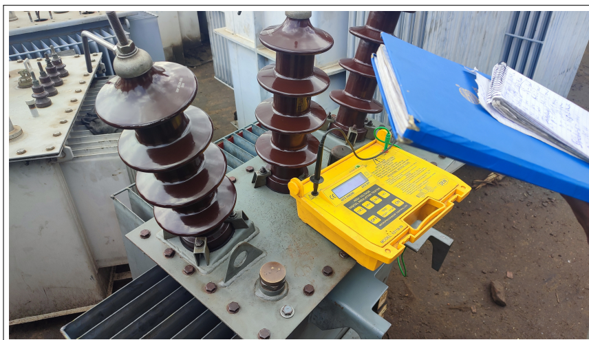
FIGURE 10 – Illustration des tests effectués avec le mégohmmètre
